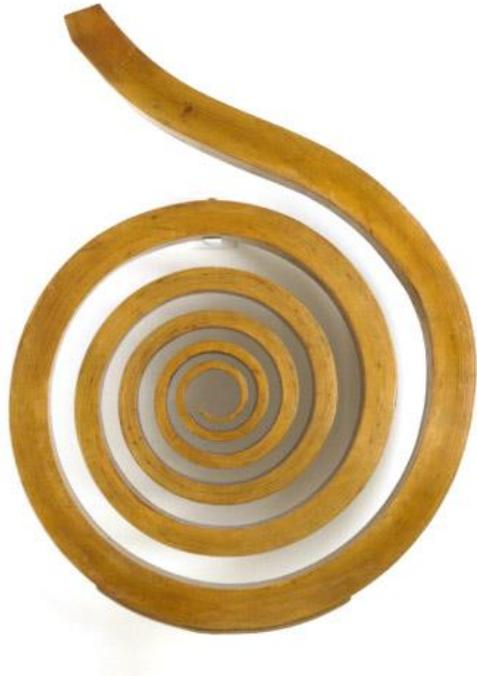
Ci mise anni a perfezionare la tecnica. Invece dell'acqua comincio ad usare il vapore (esattamente vapore a  $104^{\circ}$  per sei ore), mentre un apposito forno dove la legna asciugava per due giorni a  $70^{\circ}$  sostituì il camino del laboratorio.
